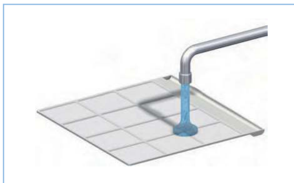
Abb. : Reinigung der Kondensatwanne
